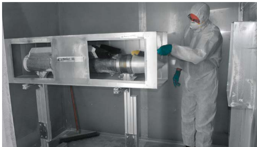
Auch Raketensysteme werden bei TechnoLab mit Sand und Staub traktiert. (© TechnoLab)
