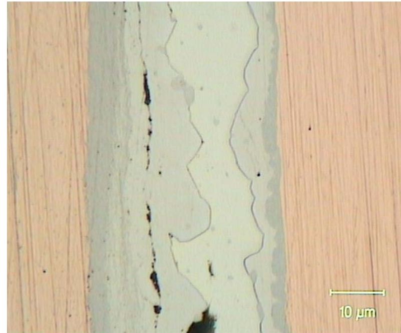
8. Intermetallische Zonen nach thermischer Alterung, freier Zinn im Lotspalt fast aufgezehrt
